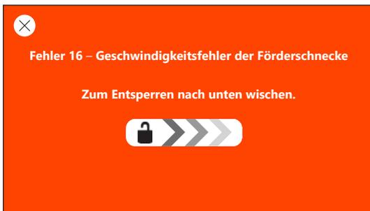
Diese Meldung auf Ihrem Display weist darauf hin, dass sich das Gerät im Sperrzustand befindet. Sie können den Fehler nun beheben, indem Sie von der Bildschirmmitte nach rechts wischen.
