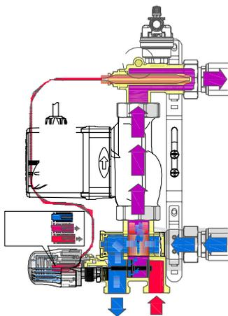
Nach Erreichen der am Thermostatkopf eingestellten Temperatur reguliert das Ventil die optimale Mischung aus heißem Primärwasser und rücklaufendem Sekundärwasser, um diese Temperatur beizubehalten. Je nach Thermostateinstellung kann das heiße Wasser nahezu vollständig abgesperrt werden, um sehr niedrige Temperaturen zu ermöglichen – besonders geeignet für die Erstinbetriebnahme von Estrichböden bis hin zu 20 °C, wenn erforderlich.
