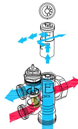
Das thermostatische Mischventil verfügt über ein Strömungssteigerungsventil, das es ermöglicht, dass Rücklaufwasser direkt in den gemischten Wasservorlauf fließt. Dadurch wird die Temperatur des gemischten Wassers, die vom Kapillarsensor ermittelt wird, abgekühlt und bewirkt, dass sich das Mischventil öffnet. Dadurch kann mehr heißes Primärwasser durch die Mischkammer fließen, was zu einer Erhöhung der Temperatur auf die am Thermostatkopf eingestellte Stufe führt.
