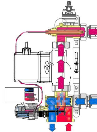
In Abhängigkeit von der Temperaturvoreinstellung des thermostatischen Kopfes schließt sich das Ventil, sobald die Temperatur der Kapillarsonde steigt. Dadurch wird das heiße Primärwasser abgesperrt, und das Rücklaufwasser behält die vom Thermostatkopf eingestellte Temperatur bei, bis zu einem Maximum von 70°C, falls erforderlich.
