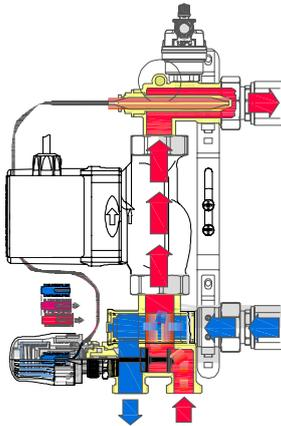
Anfangs ermöglicht das kühle Flüssigkeitsmittel im Kapillarsensor nahezu den gesamten Durchfluss des heißen Primärwassers aus der Wärmequelle durch das Ventil. Mit der Zeit steigt die Temperatur der Sonde allmählich an, wenn die Fußbodenkreise beginnen, sich zu erwärmen.
